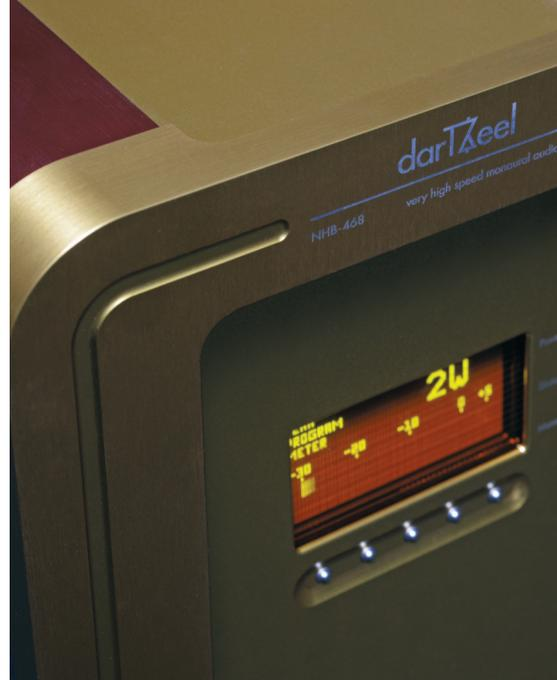
**Le travail de la face avant est digne de la bijouterie de luxe. À côté de l'afficheur, la touche menu accède aux différents paramètres. Les touches au bas de l'écran sélectionnent dans les sous-menus le type d'entrée, le gain en sortie, la mise à la masse, le comportement de l'entrée XLR, le démarrage séquentiel à distance, la luminosité de l'écran, etc.**
