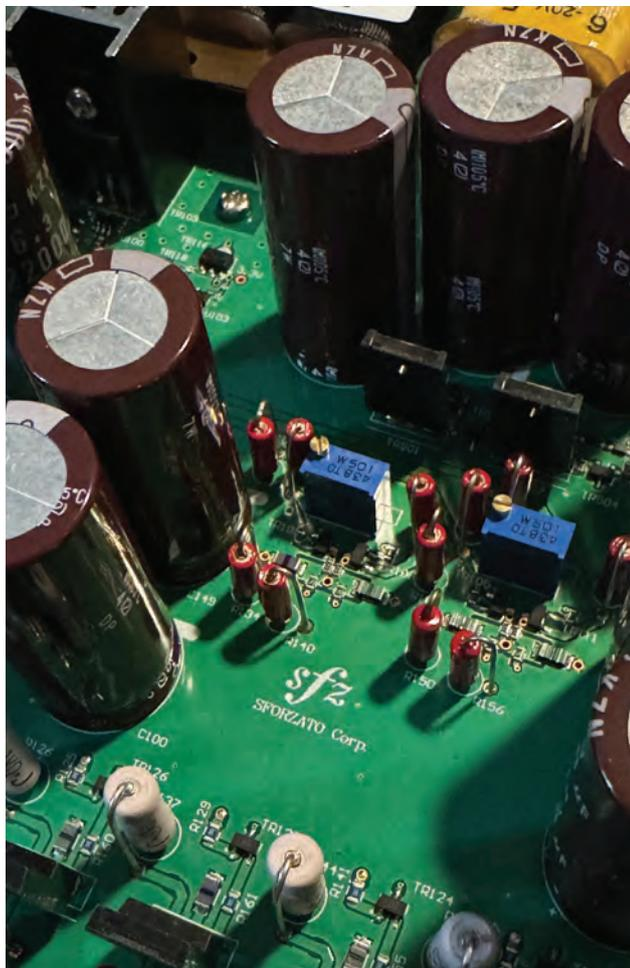
Notez l'étage de sortie discret symétrique et le copieux filtrage. À l'arrière, le DSP-09EX ne dispose pas du connecteur LAN SFP pour fibre des grands frères.
